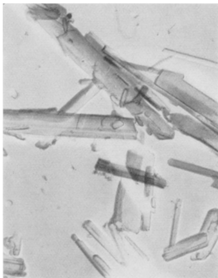
Abb. 3. Elektronenmikroskopische Aufnahme von einem im Autoklaven hergestellten Diaspor (C-Hülle)
